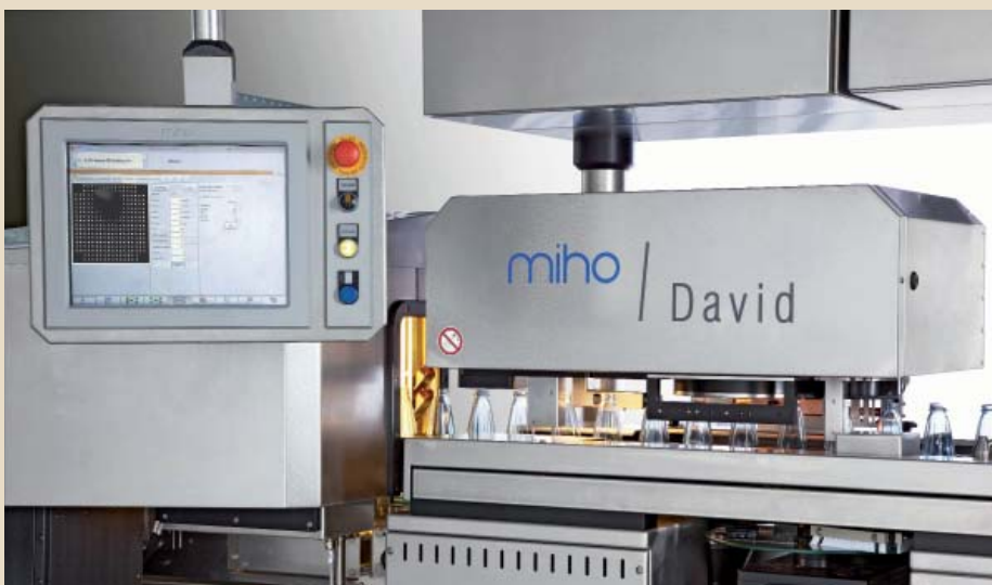
Fig. 6 Inspección de botellas vacías lavadas con nueva técnica de auto-control
