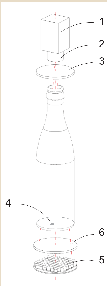
Fig. 3 Estructura de la unidad de control de fondos: (1) Cámara, (2) Objetivo, (3) Disco protector de vidrio, (4) Pedazo de suciedad, (5) Fuente de luz, (6) Disco distribuidor de la luz
