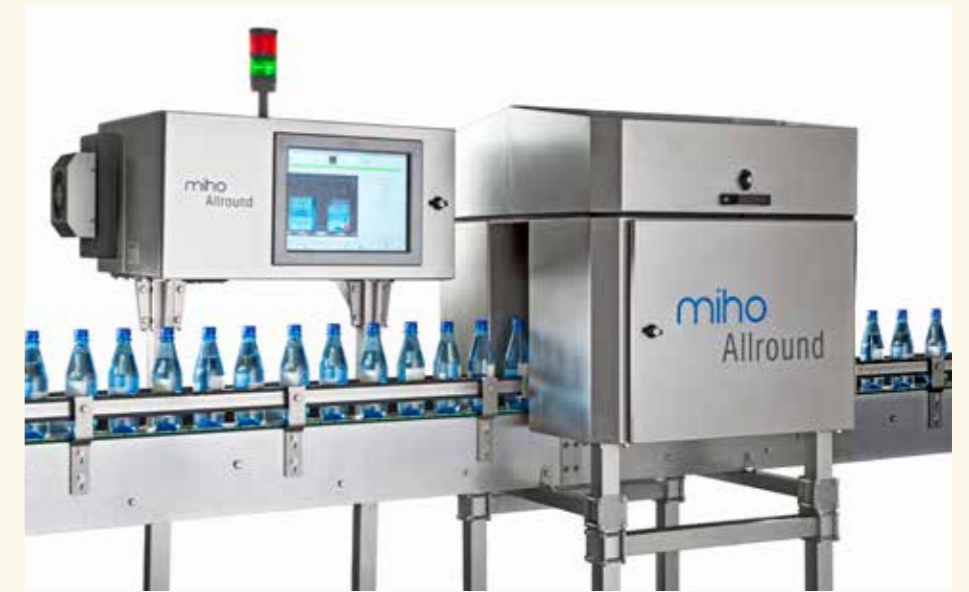
Optisches 360° Inspektionssystem zur Endkontrolle des Gebindes
