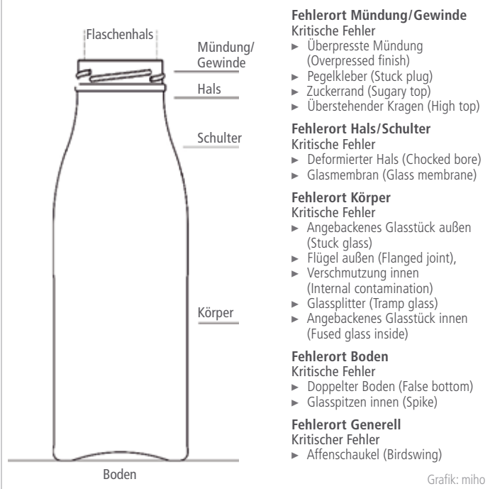
Abb. 2 | Kritische Glasfehler und ihr Auftreten, entsprechend dem Institut CETIE
