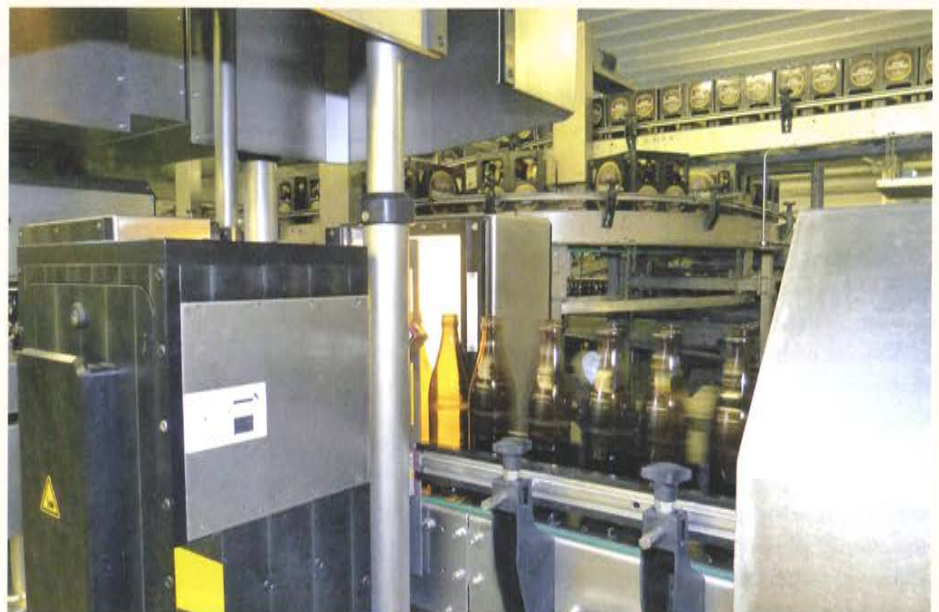
Zwei Duo-Inspektionseinheiten sorgen für eine verbesserte Seitenwandinspektion
