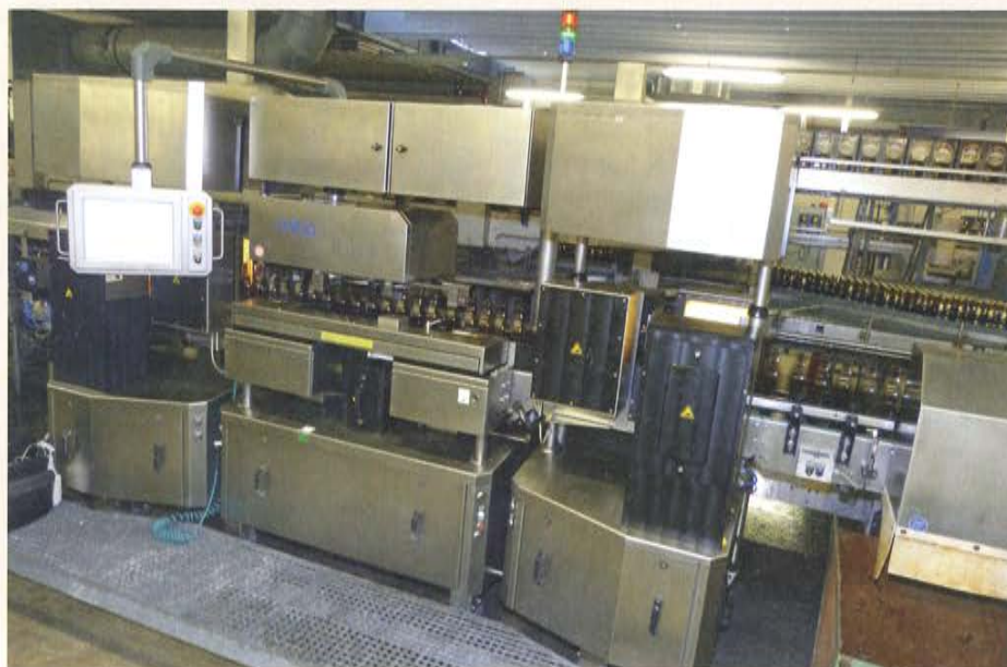
Zur Demonstration der diversen Kontrollstationen wurden alle Lichtabdeckungen zum Schutz vor Fremdlicht pneumatisch nach oben gefahren
