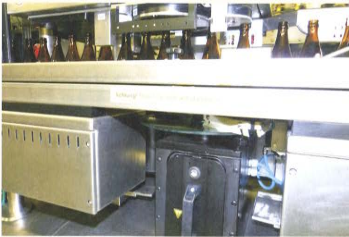
Bodenkontrolle durch eine rotierende selbstreinigende Glasscheibe
