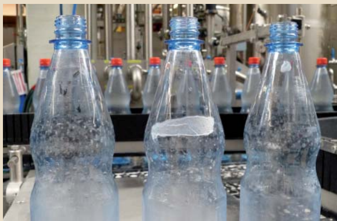
Einige der Fehler, die die Seitenwandkontrolle erkennen muss: Verschmutzungen, Etikettenreste, Aufkleber, Beschädigungen, Filzstiftbeschriftungen
