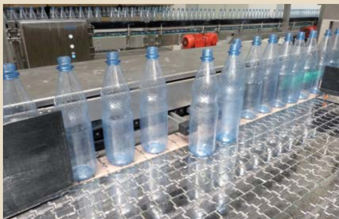
Als fehlerhaft erkannte Flaschen werden im Ausleitsystem stehend und sicher ausgeschoben
