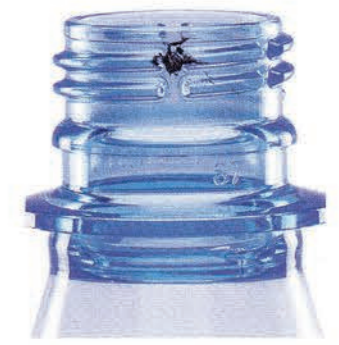
Verschmutzter Vent Slot
