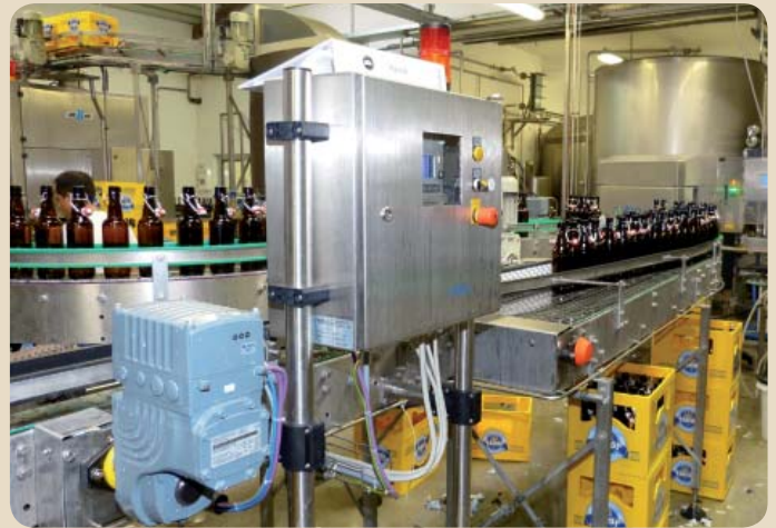
Die Bandsteuerung sorgt für das perfekte Zusammenspiel aller Flaschen-Transportbänder und neuen Energie-Effizienzantriebe
