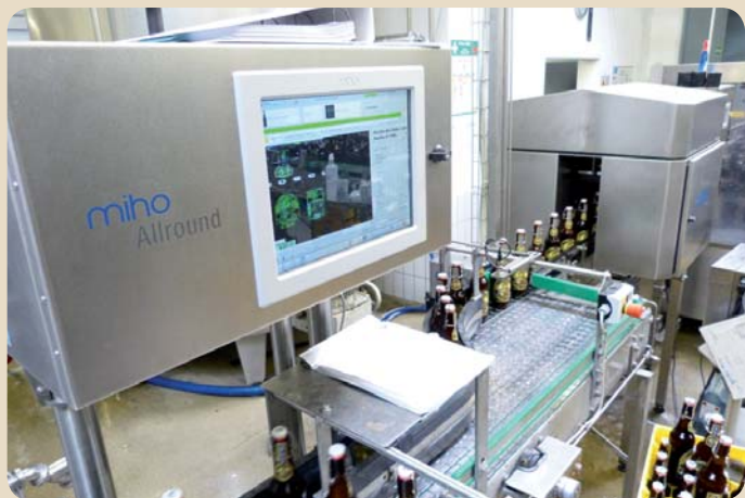
Die optische 360°-Inspektion kontrolliert die verschlossenen Flaschen auf perfekte Etiketten mit MHD, Füllstand, Klöppel-Aufdruck und Schweisser
