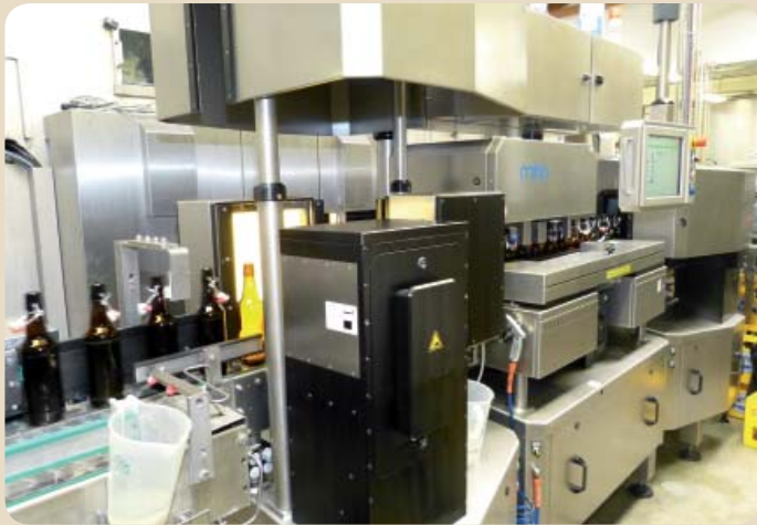
Der Leergutinspektor inspiziert nach der Waschmaschine alle Flaschen: Boden, Dichtfläche, Seitenwand, Restflüssigkeit und auch den Halsbereich der Bügelflaschen
