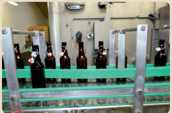
Mit der neuen Leerflascheninspektion können die Flaschenhalse von Bügelflaschen komplett kontrolliert werden, auch auf noch anhängende Etiketten
