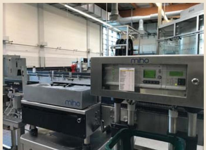
Seit über zehn Jahren tadellos im Einsatz: Dichtheits- und Füllstandskontrolle
