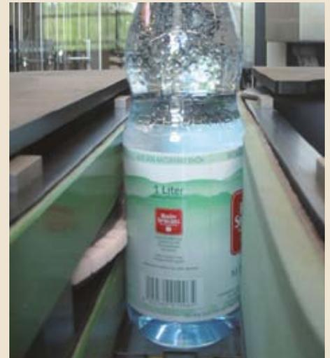
**Dichtheitskontrolle bei Kunststoffflaschen mit sanftem Druck der Fühlerfinger**
