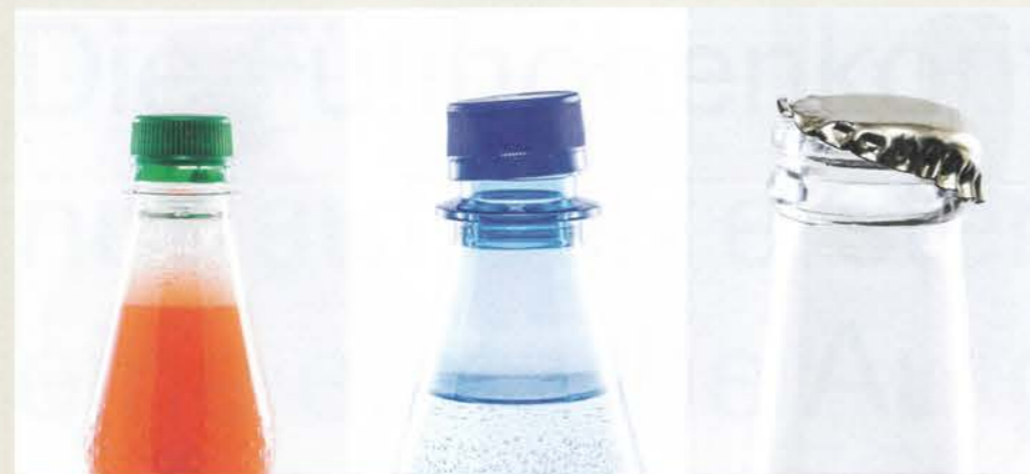
Optische Füllstands- und Verschlusskontrolle: PET-Saftflasche mit Schaumbildung, schief sitzender Schraubverschluss, Glasflasche mit „Schlafmütze“
