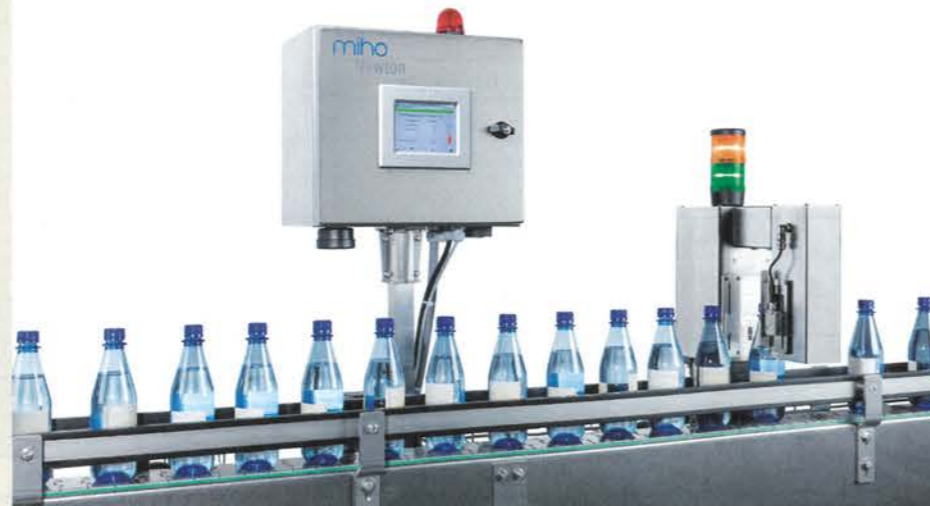
Typischer Aufbau einer Hochfrequenz-Füllhöhenkontrolle
