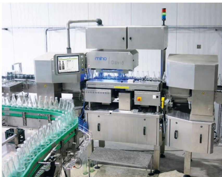
miho Pascal 2 regelt die Strecke von der Waschmaschine bis zum Füller und steuert dabei xxx Motorgruppen (maximal 16 möglich).
