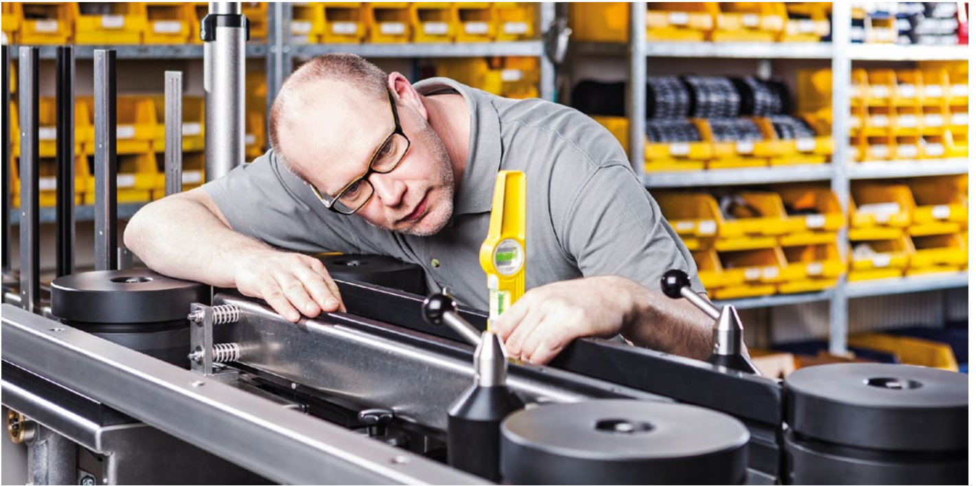
Präzision ist Trumpf: Der Industriemechaniker Marc Siebert richtet die Flaschenführung der Inspektionsmaschine „Miho David“ mithilfe einer Wasserwaage aus. Foto: miho GmbH/nh
