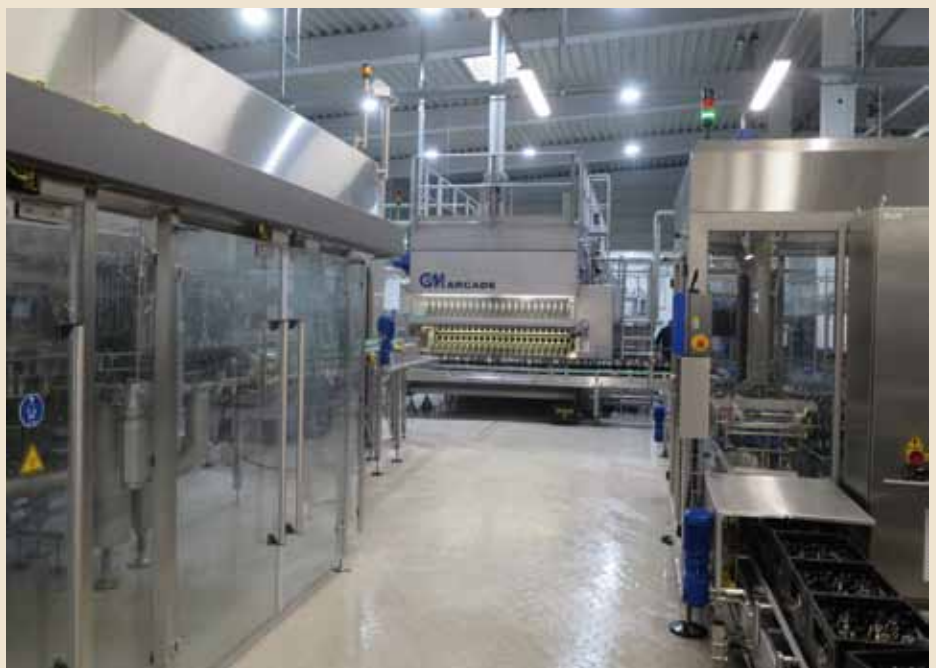
Bei der Flaschenwaschmaschine trägt eine Optimierung der Laugenströmung den speziellen Anforderungen der Bügelverschlussflaschen Rechnung
