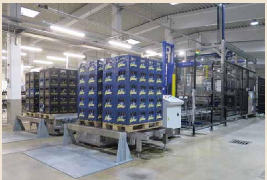
Kombinierter Ent- und Belader in Portalausführung mit integrierter Palettenkontrolle
