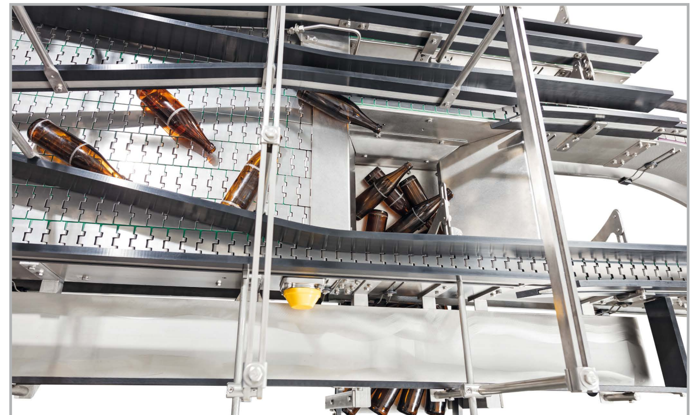
miho Conveyance, individuelle Sonderlösung zum Aufsammeln von liegenden Flaschen an schwer zugänglicher Stelle
