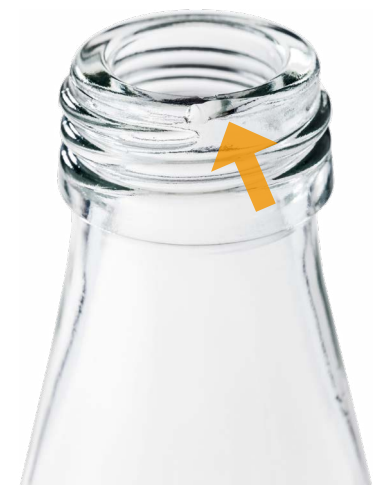
Glas: Ausbruch an der Dichtfläche
