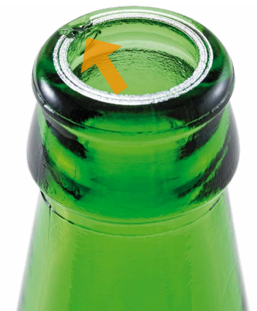
Glas: Ausbruch an der Dichtfläche
