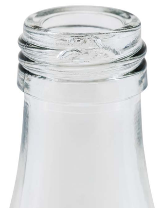
Beschädigung im Gewinde
