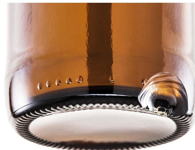
CBD: Beispiele für äußere Bodenabplatzer
