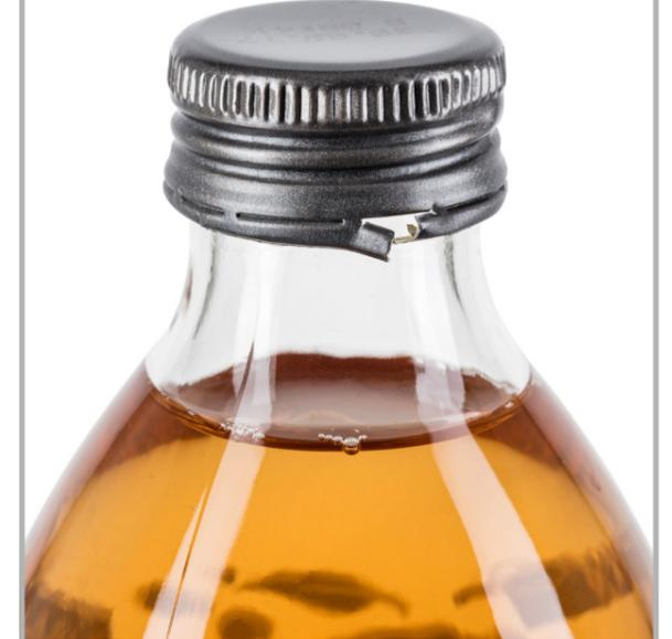
Zusätzliches Kameramodul zur 360°-Inspektion: Erkennung von Schlafmützen, gebrochenen Sicherungsringen, Code-Erkennung.
