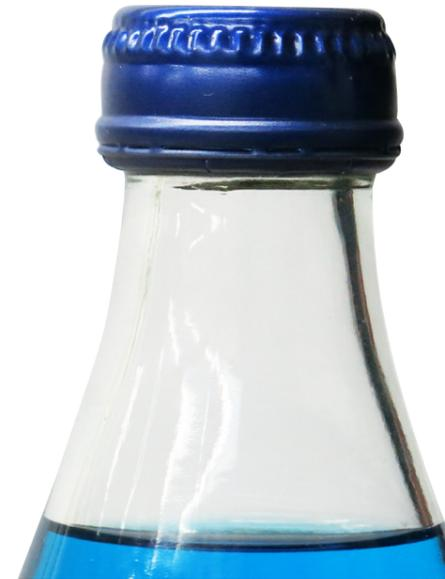
Kontrolle der Anbördelung bei Metallschraubverschlüssen.
