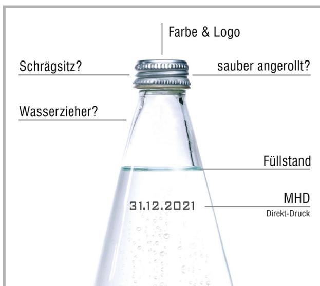
Eine integrierte Füllstands- und Verschlussinspektion mit optionalen Modulen deckt alle notwendigen Kontrollen ab.
