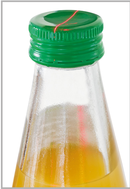
Vakuum-Prüfung bei unterschiedlichen Verschlussarten und Farben
