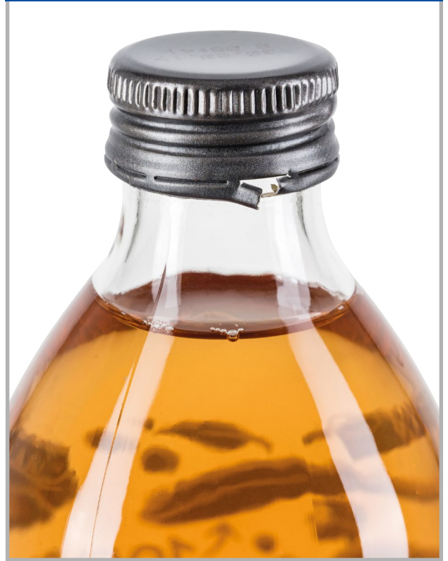
360°-Kontrolle: gebrochener Sicherungsring
